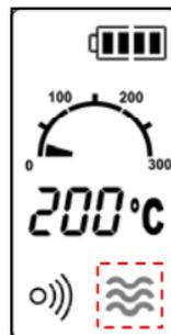
После отключения режима вибрации, индикатор «Вибрация» на дисплее должен погаснуть, при повторной активации - снова загореться.
