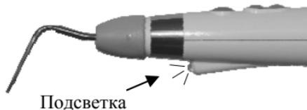
**Примечание:** При установке блока управления с включенной подсветкой в гнездо зарядки на подставке зарядного устройства, подсветка автоматически отключается. При извлечении блока управления из гнезда зарядки - снова включается.
